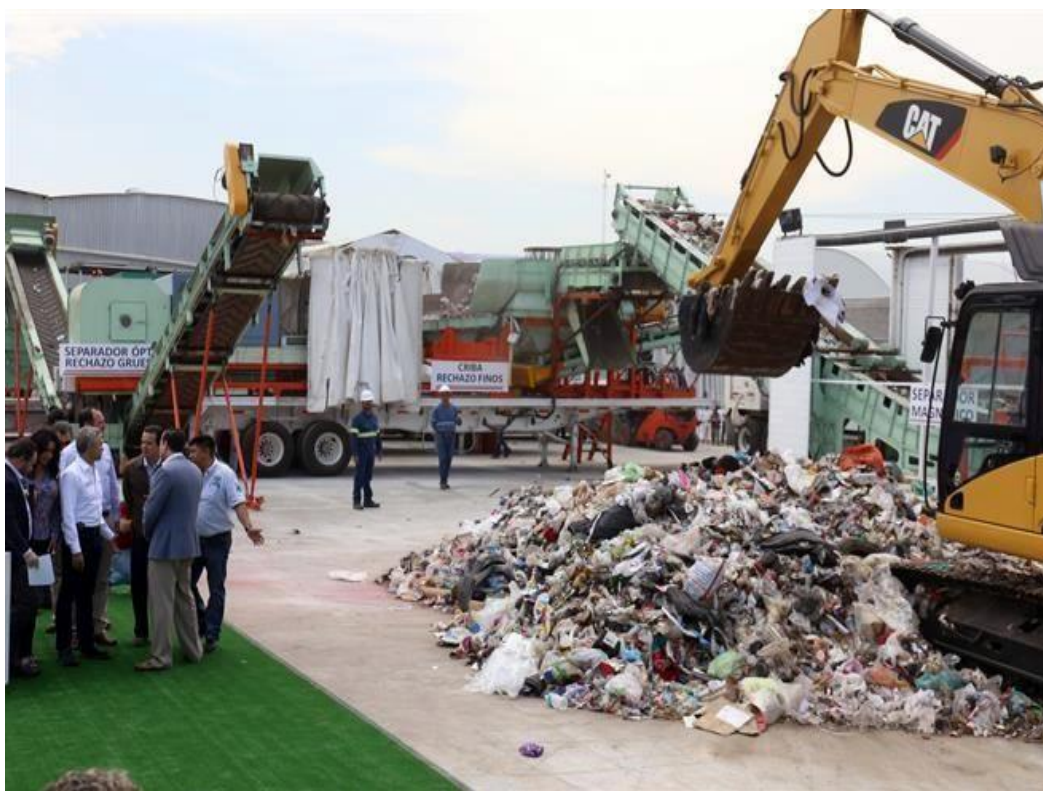
Figura 13. Planta prensadora de residuos sólidos para la generación de CDR. Descarga el 16/01/20. Recuperada de https://img.gruporeforma.com/imagenes/elementorelacionado/5/473/4472047.jpg
