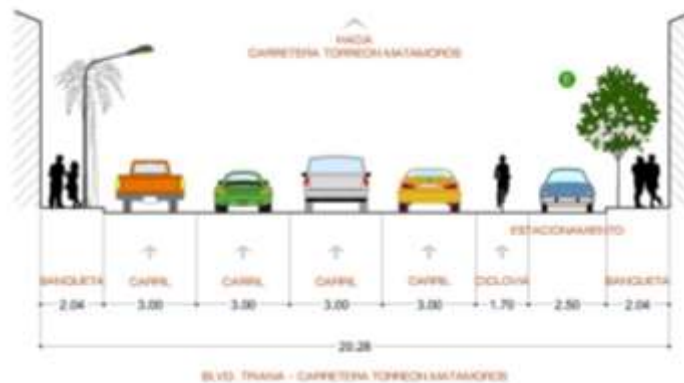
Imagen 359. Sección propuesta calzada División del Norte
