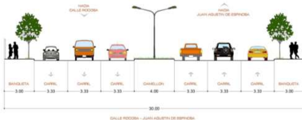
Imagen 410. Sección actual Oriente Torreón
