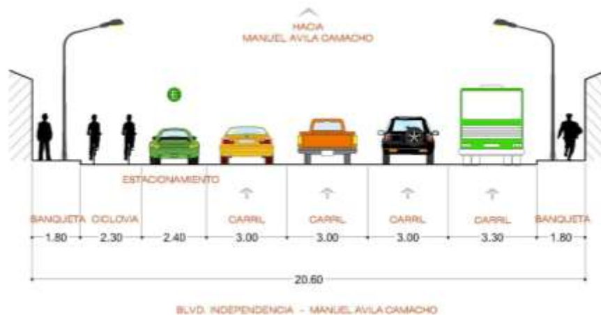
Imagen 347. Sección propuesta Calzada Abastos
