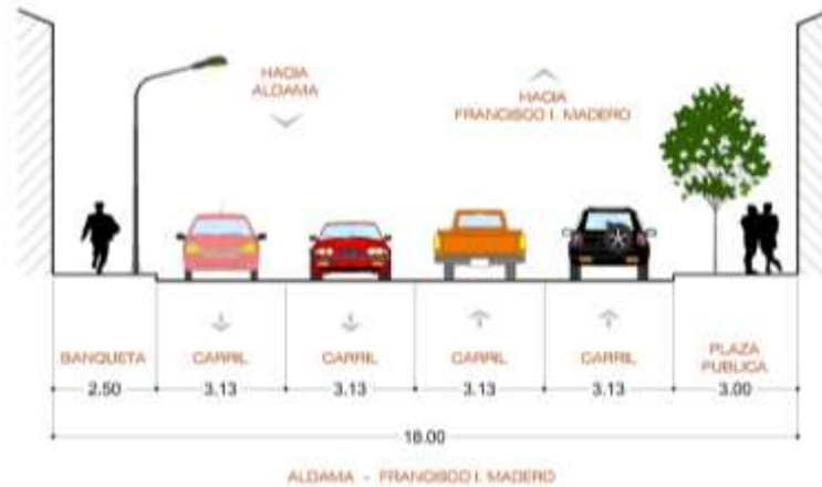
Imagen 144. Sección actual de la calle Independencia
