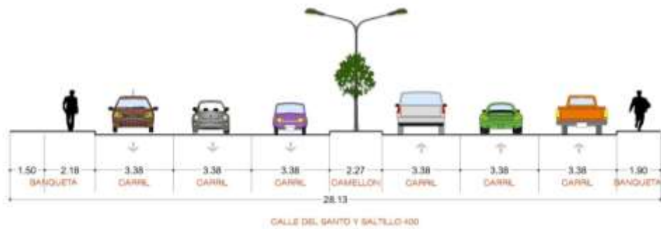
Imagen 256. Sección actual del Boulevard Diagonal de las Fuentes
