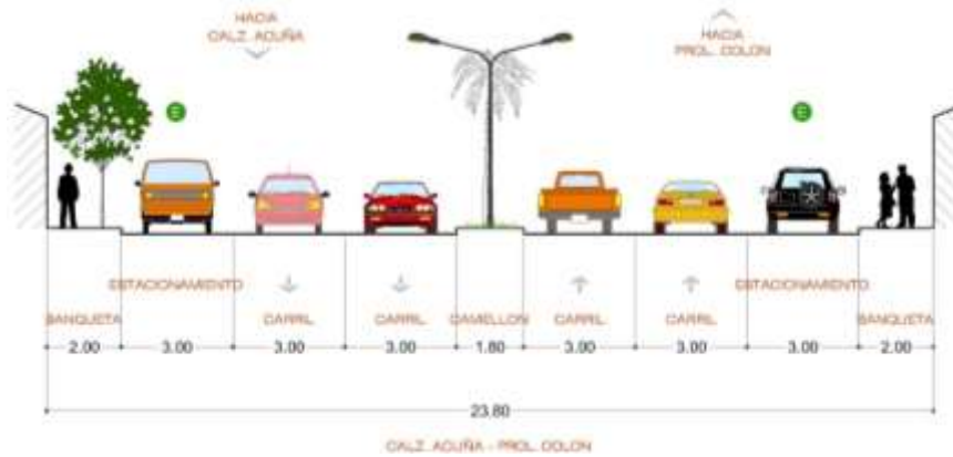
Imagen 266. Sección actual del Boulevard Constitución (tramo 2)
