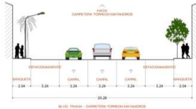
Imagen 358. Sección actual calzada División del Norte
