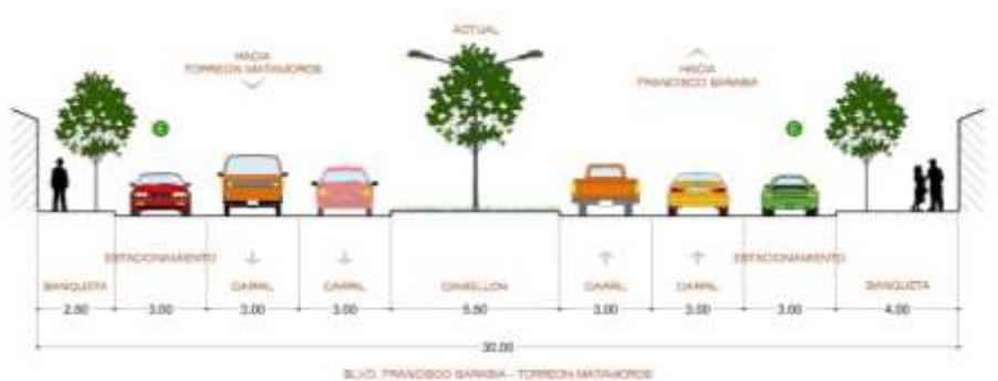
Imagen 366. Sección actual calzada México
