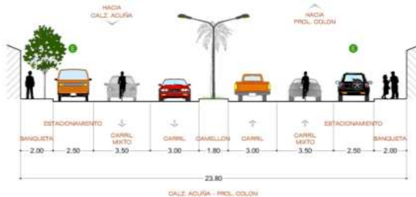
Imagen 267. Sección propuesta del Boulevard Constitución (tramo 2)
