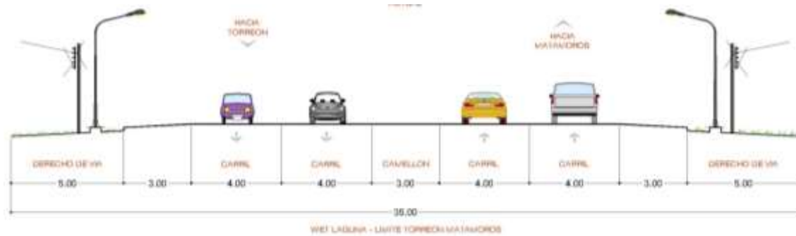
Imagen 294. Sección actual de la carretera Torreón – Matamoros
