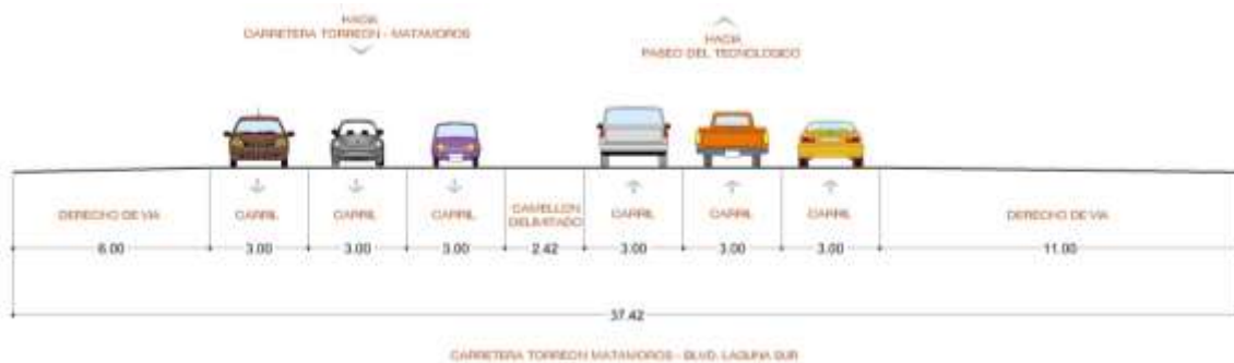
Imagen 276. Sección actual de carretera Mieleras
