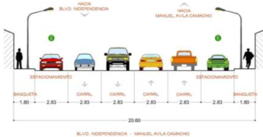
Imagen 346. Sección actual Calzada Abastos
