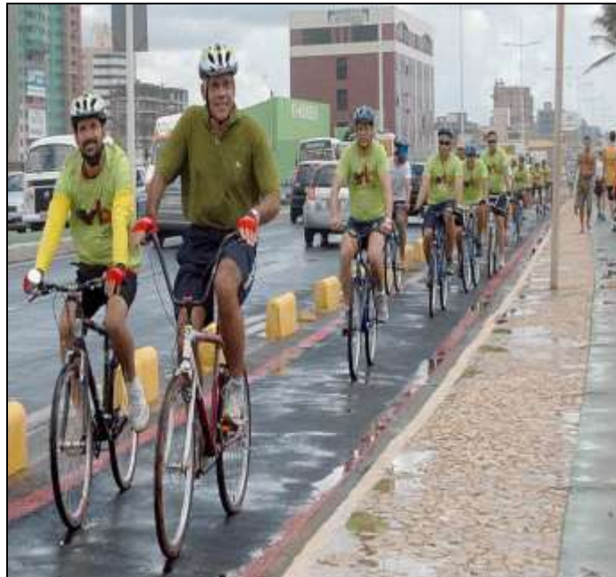
Imagen 232. Ciclovía segregada a nivel de arroyo
